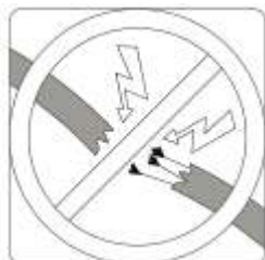
Verificar fios danificados
