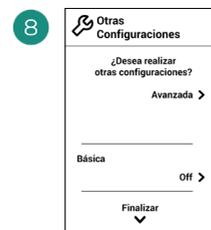
Finalice el proceso. Desde Airzone Cloud, acceda a la configuración avanzada y/o active la función básica\* (esta última permite on/off, ajuste de velocidad, ajuste de modo de funcionamiento y ajuste de temperatura).
