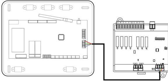
Las características de los relés de control ①②③④⑤ son 24 / 48 Vac libre de tensión. Para el control de elementos de mayor potencia se recomienda el uso de contactores de la potencia a controlar.
