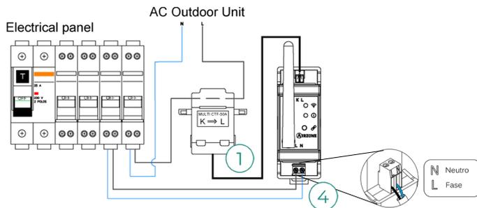
La conexión de alimentación eléctrica al módulo (4) se realiza mediante una borna de 2 pines. Fije los cables con los tornillos de la borna respetando la polaridad de la misma.
