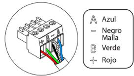
**Importante:** Para elementos con alimentación externa a 110/230 Vac, solo es necesario conectar los polos “A”, “B” y “Malla” del bus para las comunicaciones. Utilice la malla únicamente en el conector del lado de la central.
