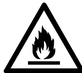
ADVERTENCIA: Riesgo de incendios
