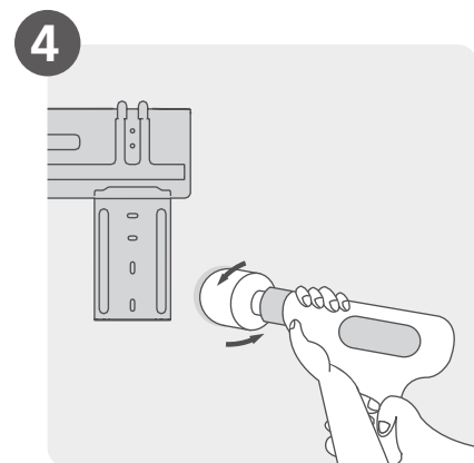
Percez un trou dans le mur
